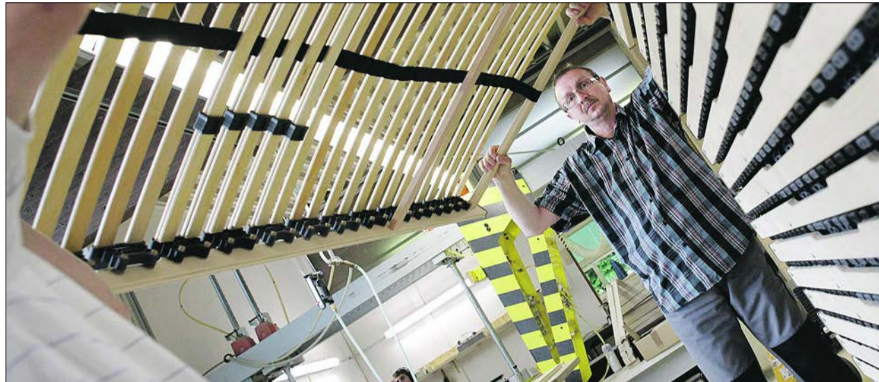
Matratzenrahmen werden von den Lübbecke Werkstätten für mehrere Unternehmen aus der Region produziert. Mithilfe moderner Maschinen werden die Sperrholzplatten für die Rahmen zugeschnitten, Profile gefräst und Löcher gebohrt. Fotos (2): Hendrick Schmalhorst
